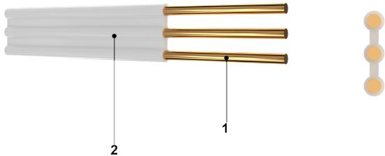
1. ТОКОПРОВОДЯЩАЯ ЖИЛА - медная однопроволочная, круглой формы, соответствует классу 1 ДСТУ EN 60228.
