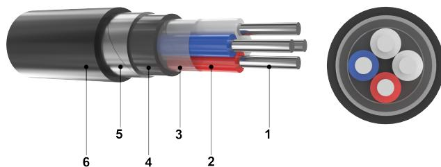
1. ТОКОПРОВОДЯЩАЯ ЖИЛА - алюминиевая однопроволочная, круглой формы, соответствует классу 1 ДСТУ EN 60228:2015.
