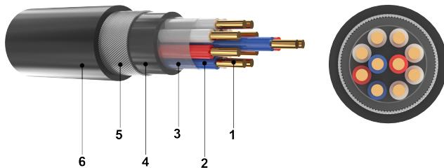
1. ТОКОПРОВОДЯЩАЯ ЖИЛА - медная однопроволочная, круглой формы, соответствует классу 1 ДСТУ EN 60228: 2015.
